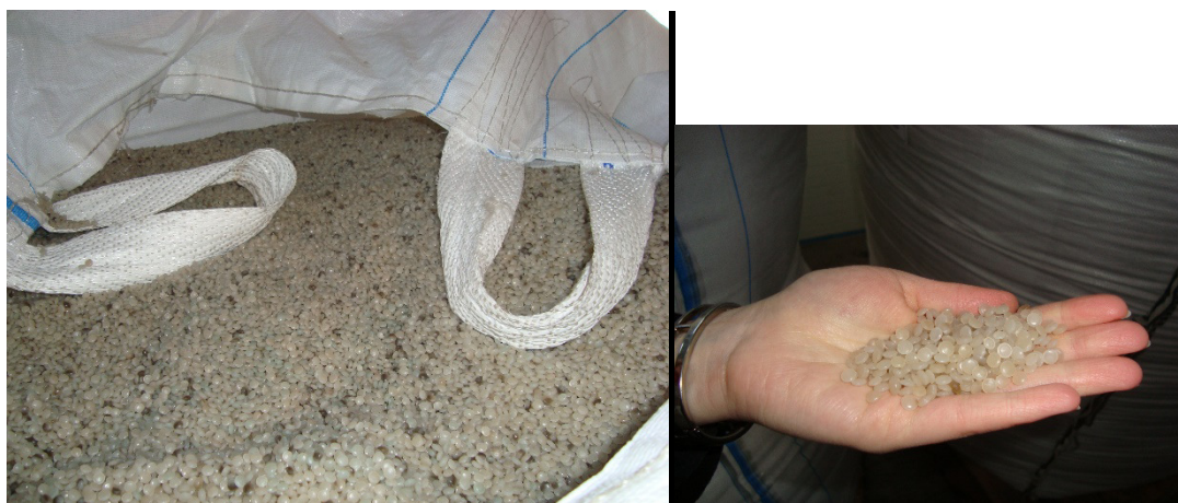
Pav. 5. Tolimesniam naudojimui iš antrinių žaliavų paruoštos plastikų granulės
