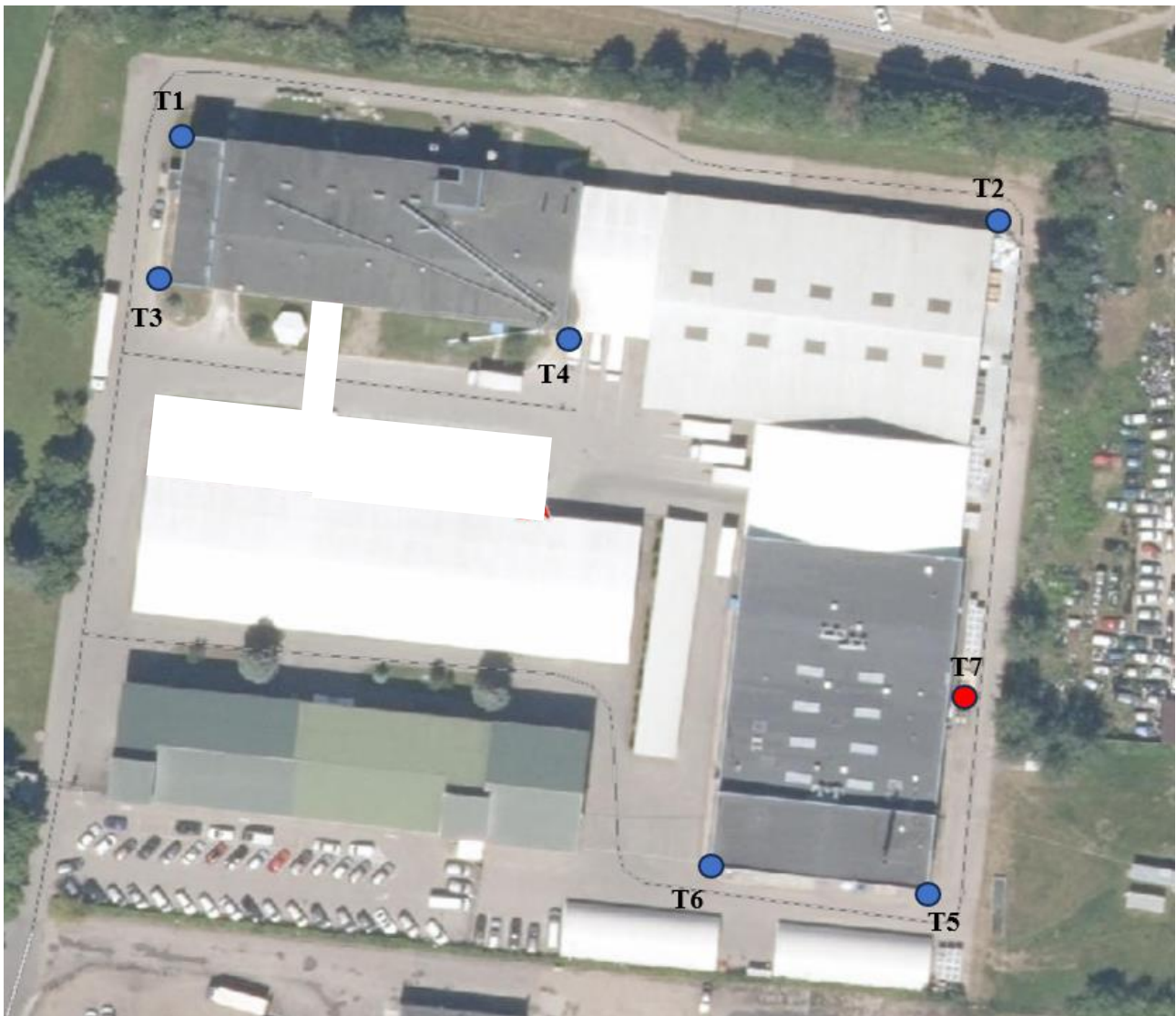
Pav. 20. Garso lygio matavimo taškai UAB „BEWI Lithuania“: T1 - T6 - prie pastatų ribų (kampų); T7- šalia atviro stacionaraus taršos šaltinio
